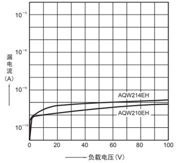
9. - (2) 漏电流—负载电压特性
